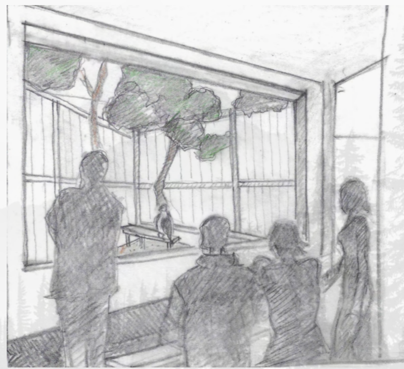
2 Παράθυρο με ανακλαστική μεμβράνη Με το υλικό αυτό δίνεται η δυνατότητα να παρατηρήσει ο επισκέπτης το εσωτερικό του κλωβού χωρίς να γίνει αντιληπτός στα πουλιά. Το πάχος της μεμβράνης είναι 0,6χιλ. και η διάσταση του φύλλου ορίζεται στα 6,00μ x 3,21μ.
